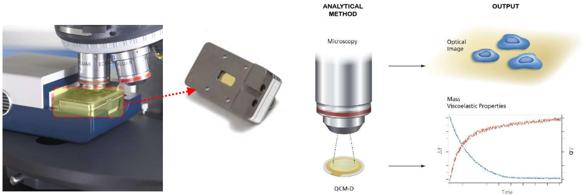
顕微鏡モジュールはQSense Explorerに追加可能なオプションです。モジュール中央部の光学窓を通じて、センサーの反応部を顕微鏡に設置の対物レンズから拡大して覗くことで視覚的に観察することが可能です。
