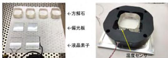
図7 左は 1/8Å ブロックに用いた光学部品, 右は素子ホルダと素子,
